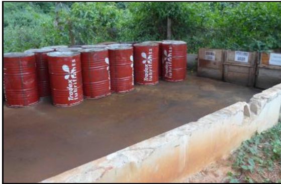
GARAGE CONCASSEUR : STOCKAGE PROPRE DES HUILES USEES
