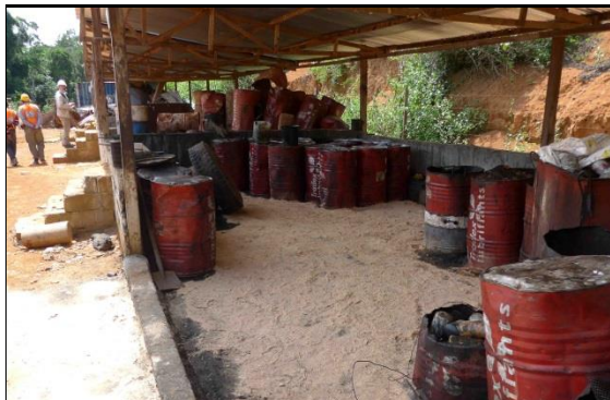
SITE DECHETS : STOCKAGE CORRECT DES HUILES ET FILTRES USES
