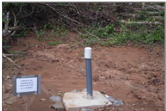
L'UN DES 3 FORAGES REALISES POUR LE SUIVI DE LA QUALITE DE LA NAPPE AU SITE DECHETS
