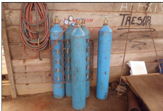
ATELIER EQUIPEMENT GENERAL: DES BOUTEILLES NON SECURISEES CONTRE LA CHUTE
