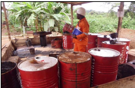
GARAGE PRINCIPAL: STOCKAGE TEMPORAIRE D'HUILES USEES EST CONFORME
