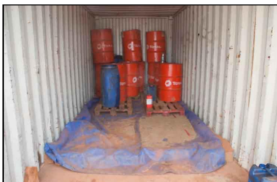
STOCKAGE DES DECHETS DANGEREUX ET RECYCLABLES EN CONTENEURS FERMES
