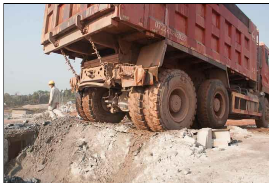
CONCASSEUR: RAIL D'ARRET CAMION NON FONCTIONNEL: RISQUE D'ACCIDENT
