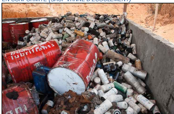
STOCKAGE PRINCIPAL AVEC FILTRES A HUILE ET HUILES USEES QUI NECESSITE UN REAMENAGEMENT DU DEPOT
