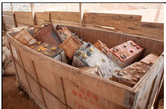
STOCKAGE DES BATTERIES: ELLES DOIVENT ETRE CORRECTEMENT EMPILEES (PAS D'ECOULEMENTS D'ACIDE)
